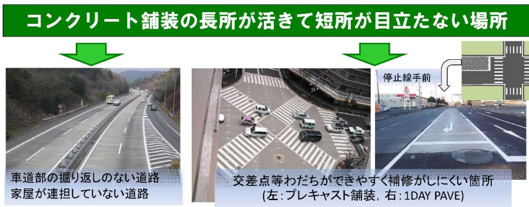
図 8-2. コンクリート舗装が適している場所の例
