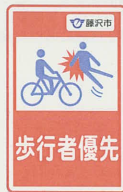
自転車と歩行者の錯綜が懸念される箇所での注意を促すための路面標示（イメージ）
