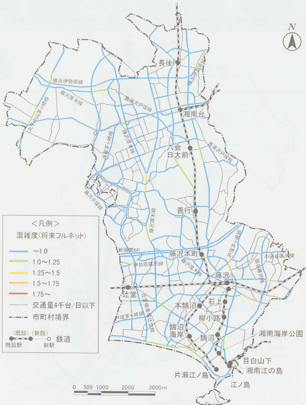
■ 将来道路混雑度（2030年（平成42年））：全ての都市計画道路が整備された場合
